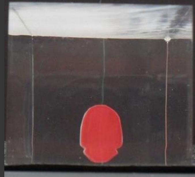
Zdjęcia kolejnych obrazów czerwonego kółka widocznych przez kawałek pleksi podgrzewany od dołu. Zdj. wykonano w IF US
